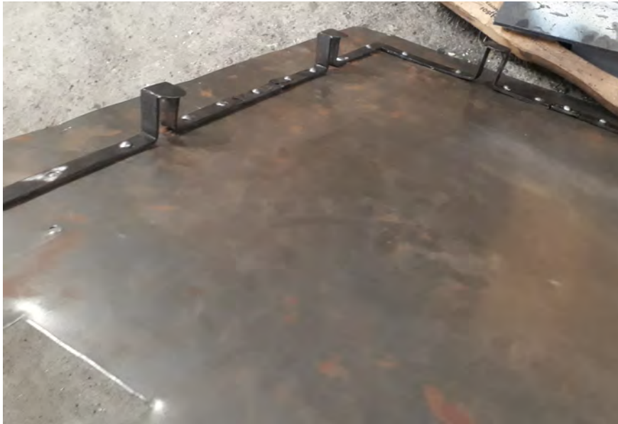
Abbildung 16: Einnieten des Rahmens auf neues Blech
