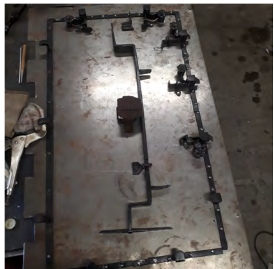
Abbildung 20: Einsetzen der Riegel
