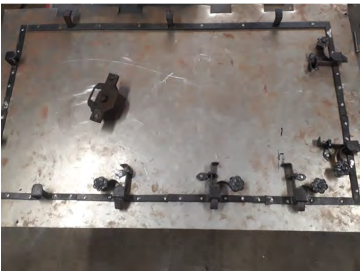
Abbildung 19: Einsetzen, Ausrichten, Befestigen der Riegel
